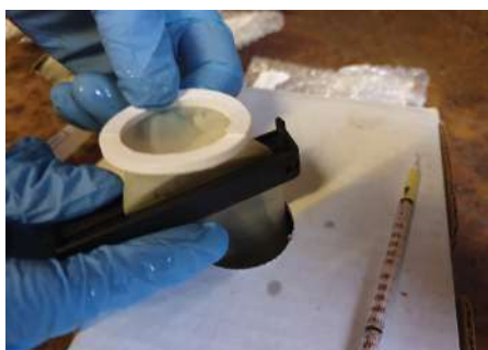
Fig. 3: A continuación, se inserta la funda en el kit de prueba para su análisis.
