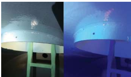
Fig. 2: Las áreas de color rosa que se iluminan bajo la luz LED segura para la vista (derecha) muestran dónde el espesor de la película es insuficiente. Las áreas con espesor de recubrimiento insuficiente suelen aparecer alrededor de las costuras y bordes de las soldaduras, donde es difícil garantizar un espesor de recubrimiento adecuado.
