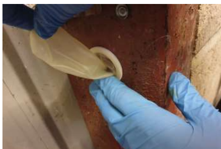
Fig. 2: El método de prueba de la manga de látex comienza colocando la manga en la superficie y frotando la solución contra ella durante aproximadamente dos minutos antes de retirar la manga.
