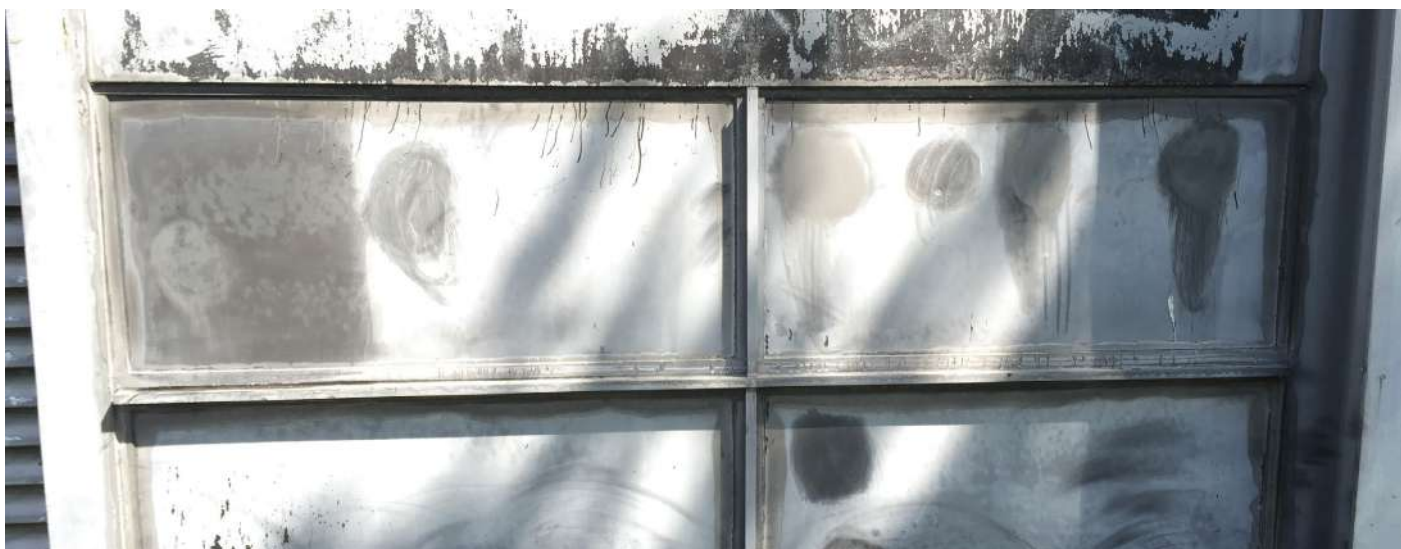
Imagen: Para identificar las áreas con aceite de silicona, se roció un área, se identificó la formación de gotas, luego se limpió el agua, se lijó el área y luego se roció nuevamente para ver si el agua seguía formando gotas o no.
