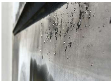
Imagen: Sobre un sustrato de apariencia perfectamente uniforme, el agua formó gotas pronunciadas en una zona, pero gotas aplanadas en otra.
