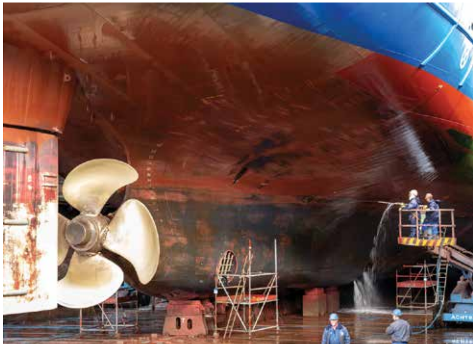
El uso de chorro de agua UHP para preparar superficies de acero podría adaptarse para producir un perfil de superficie para nuevas aplicaciones de construcción.
