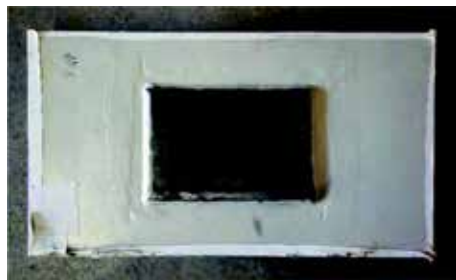
Figura 2: Antes de comenzar los ensayos, se retiró el recubrimiento de la almohadilla de refuerzo para cumplir con la norma SSPC-SP 11 de limpieza de herramientas eléctricas hasta dejar el metal al descubierto.
