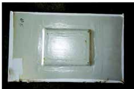
Figura 1: El material base de la placa de prueba utilizada en todos los ensayos consistía en una placa de acero A36 de 6 mm de espesor con una almohadilla de refuerzo de acero A36 de 6 mm de espesor soldada en su lugar, lo que resultaba en un espesor total de la placa de prueba de 12,7 mm.
