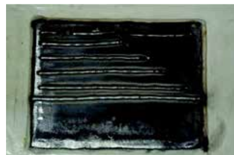
Figura 3: La primera fase de las pruebas consistió en realizar una soldadura superficial de 1/8 de pulgada (refuerzo) a la almohadilla de refuerzo en pasadas separadas, comenzando con una longitud de 1 pulgada y continuando con pasadas posteriores que aumentaban 1 pulgada cada una hasta alcanzar una longitud total de 8 pulgadas.
