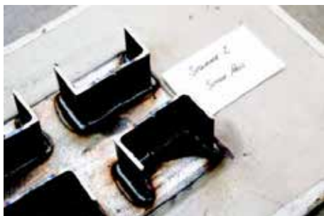
Figura 7: Se consideró razonablemente que esta única pasada de 30,5 cm (12 pulgadas) generaría suficiente calor como para provocar la falla del sistema de recubrimiento al exceder su resistencia al calor seco.
