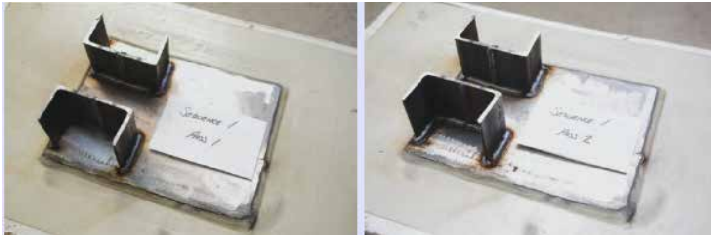
Figuras 5 y 6: La primera prueba de la Fase Dos consistió en dividir la soldadura del canal al panel de prueba en dos pasadas: una pasada posterior a lo largo del borde exterior del canal y una pasada frontal a lo largo del borde interior, dejando tiempo para el enfriamiento entre pasadas.
