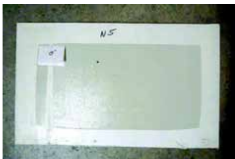
Figura 4: Si bien se superó la resistencia al calor seco del poliuretano en las dos últimas muestras, no se observaron daños visibles en el sistema de recubrimiento.
