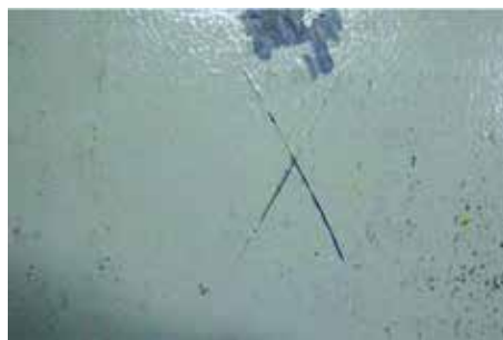
Figura 8: Se realizó una prueba de adhesión de corte transversal según la norma ASTM D3359 y los resultados cumplieron con una calificación 2A (remoción irregular a lo largo de la mayoría de las incisiones de hasta 3,2 mm [1/8 de pulgada] a cada lado).
