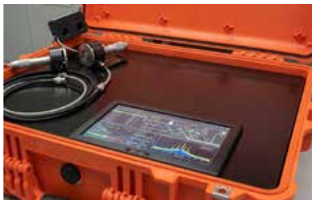
Figura 5: Monitor remoto para verificar las condiciones de la obra a distancia. Cortesía de DRYCO.
