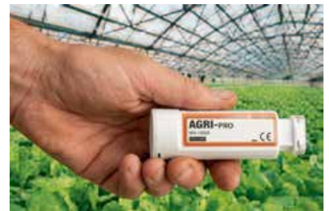
Figura 4: Registrador electrónico de datos de temperatura y humedad relativa. Cortesía de Onset Computer Corporation.
