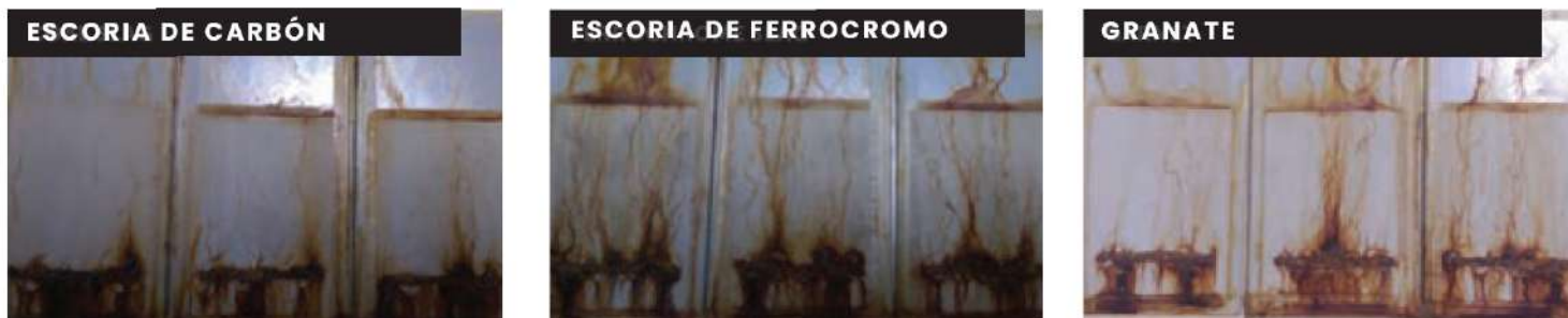
FIG. 7: En la imagen se muestran las muestras de ensayo después de la prueba Norsok M501.
