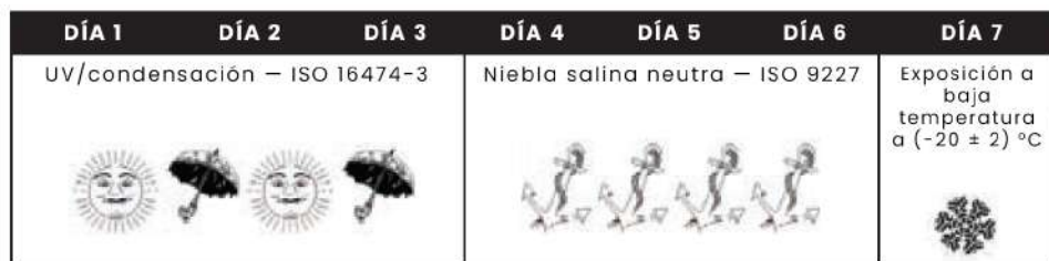
FIG. 2: Esta imagen muestra un ciclo del programa de pruebas cíclicas ISO 20340.
