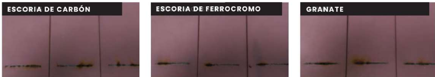
FIG. 6: Estas imágenes muestran el estado de las muestras después de la prueba de inmersión en agua de mar.
