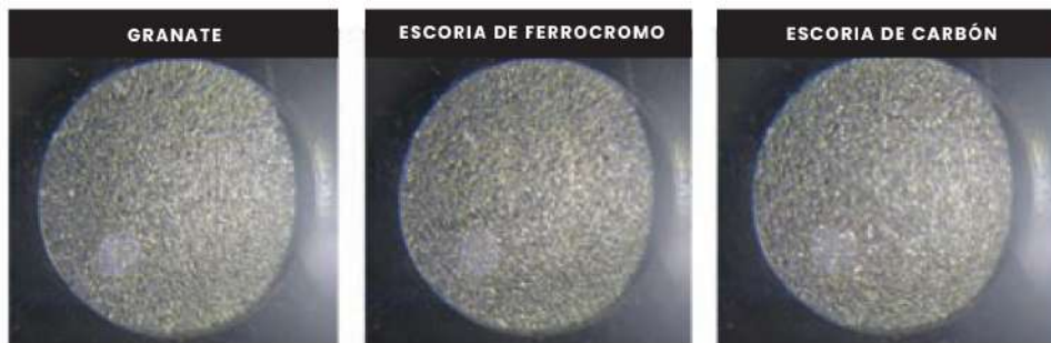
FIG. 4: Se muestra la morfología superficial de las muestras de ensayo después del granallado.
