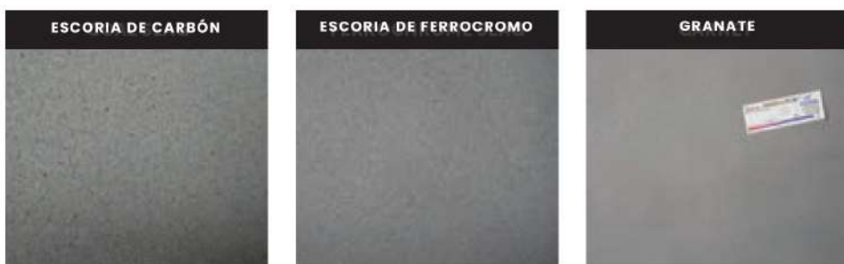
FIG. 5: Se muestra el estado superficial de paneles recubiertos con diferentes abrasivos después del granallado.
