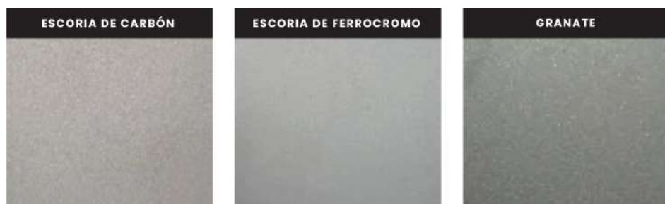
FIG. 3: Se muestran las condiciones superficiales de paneles sin recubrimiento sometidos a granallado con diversos abrasivos.
