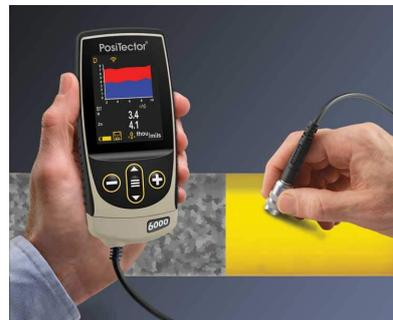
El medidor de espesores de revestimiento dúplex PosiTector 6000 FNDS mide los espesores individuales de las capas de pintura y de zinc en un sistema de revestimiento dúplex con una sola lectura.
