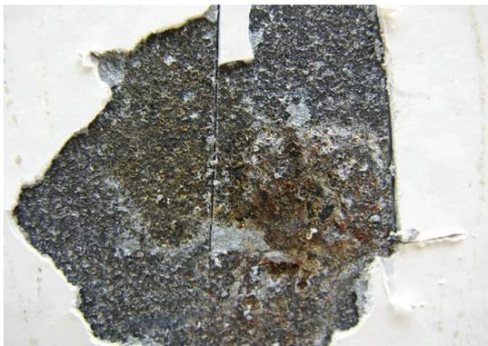
FOTO: CORTESÍA DE KTA-TATOR, INC. / FIG. 5: En algunas zonas, debajo de las ampollas se apreciaba óxido rojo y corrosión blanca del zinc.
