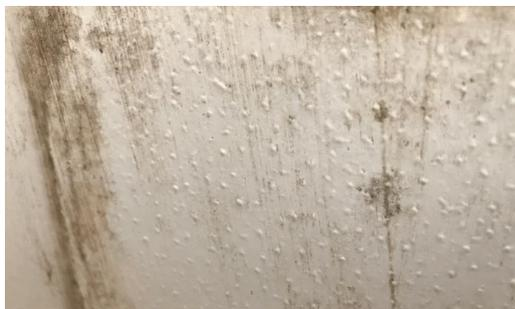
FOTO: CORTESÍA DE KTA-TATOR, INC. / FIG. 3: Un patrón de pequeñas ampollas estaba presente bajo las correas que aseguraban la cubierta.
