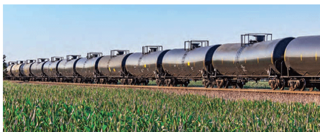
Fig. 2: Los vagones cisterna contienen principalmente productos alimenticios húmedos, por lo que requieren recubrimientos compatibles con el contacto con alimentos húmedos. Se limpian después de cada descarga con vapor a alta temperatura y, por lo tanto, deben ser compatibles con las temperaturas elevadas y el choque térmico asociado.
