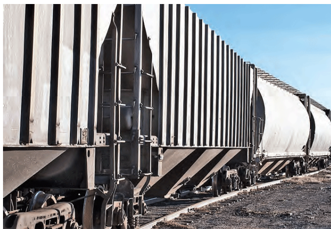
Fig. 1: Los vagones tipo tolva almacenan principalmente productos alimenticios secos con recubrimientos compatibles con el contacto indirecto con alimentos. FOTO: CORTESÍA DE SHERWIN-WILLIAMS PROTECTIVE & MARINE
