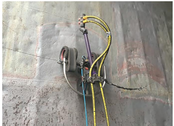
FIG. 1: Las unidades automatizadas de preparación de superficies pueden fijarse a los cascos de los buques para eliminar el recubrimiento
