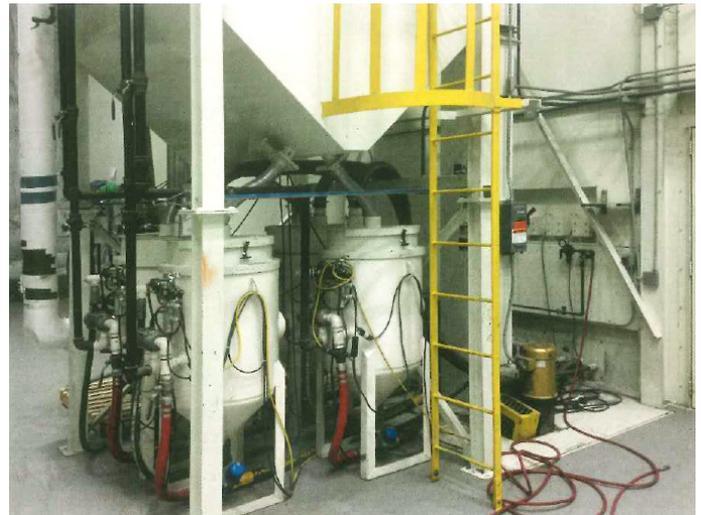
El proceso básico de chorreado implica una fuente de aire comprimido (el compresor) para mover el aire en volumen suficiente a un recipiente (caldero de chorreado) que añade (por dosificación) abrasivo almacenado al aire entrante y luego empuja la mezcla de aire y abrasivo a la chorreadora a través de una manguera de chorreado para que la chorreadora limpie y perfile la superficie.
