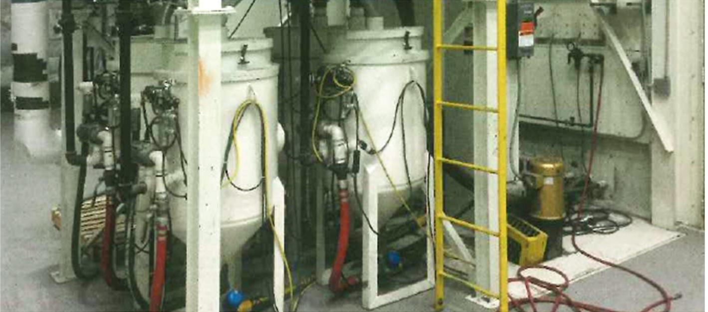
La limpieza por chorro abrasivo con boquilla seca es uno de los métodos predominantes de preparación de superficies en la industria de la pintura industrial. Cuando se realiza correctamente, el proceso limpia y perfila la superficie más rápidamente que otros métodos de preparación de superficies.
